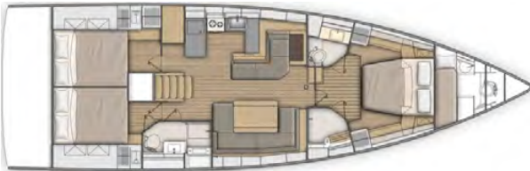
Version 3 Kabinen 3 Toiletten:
